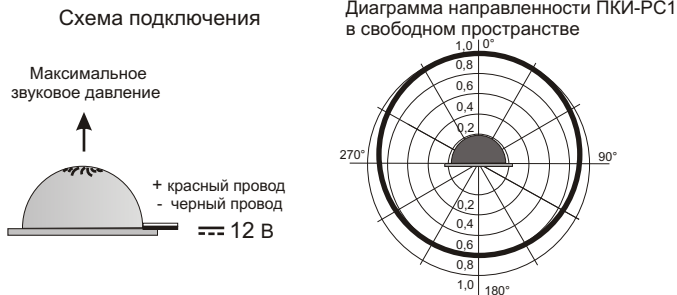
Рис.2 Схема подключения и диаграмма направленности Оповещателя ПКИ-РС1.
