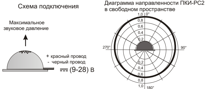
Рис.2 Схема подключения и диаграмма направленности Оповещателя.
