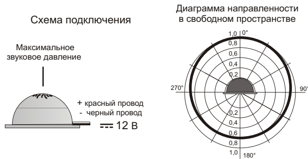
Рис.2 Схема подключения и диаграмма направленности звука оповещателя.
