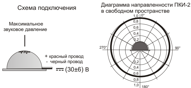
Рис.2 Схема подключения и диаграмма направленности оповещателя ПКИ-2.
