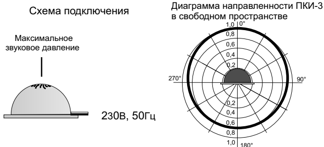
Рис.2 Схема подключения и диаграмма направленности оповещателя ПКИ-3.
